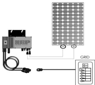
Wechselstrom (AC) anschließen
