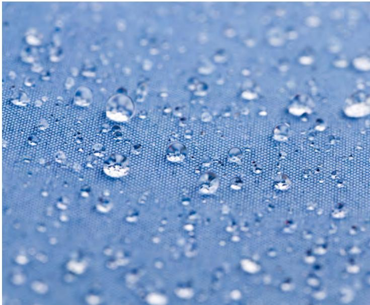
Wasser oder wässriger Schmutz perlen von einem **wasserabweisenden Stoff** ab. Dadurch bleibt dieser sauber und trocken. In der Fachsprache wird dieser Effekt „hydrophober Effekt“ genannt. Wasserabweisende Stoffe werden z.B. bei Outdoor-Bekleidung oder Heimtextilien eingesetzt. Die wasserabweisenden Ausrüstungen werden in speziellen Verfahren auf die Stoffe aufgebracht.
